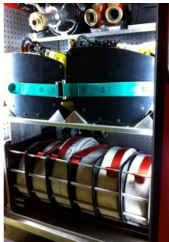
Bilden visar slangutläggning med QuickBag slangväska.
