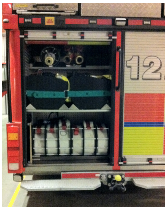
Brandslang i QuickBag slangväskor på insatsbil vid Uppsala Brandförsvär. Ordningen ombord skapar effektiva insatser.
